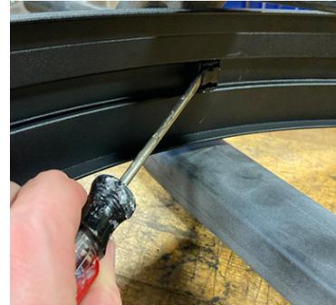
2B: Schrauben Sie die mittige Schutzblechschaube mit einem 4-mm-Inbusschlüssel heraus (Sie können die Schraube entsorgen – es wird eine neue Schraube bereitgestellt)
