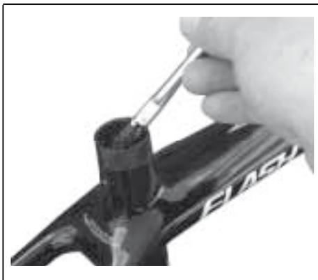
3. Aplique una pequeña cantidad de grasa de rodamientos para bicicleta debajo del cierre del tubo vertical. Vuelva a instalar el cierre de sillín. **Asegúrese de alinear la abertura de la abrazadera del cierre con la ranura del tubo vertical**
