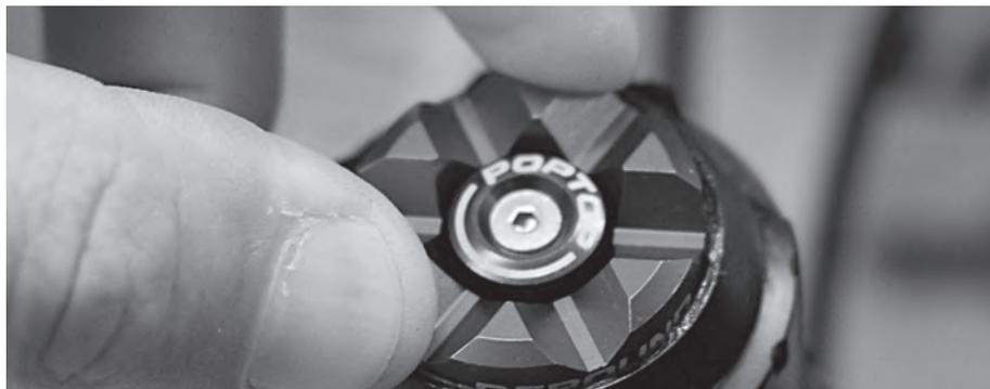
Faites tourner la molette vers le “-” (sens contraire des aiguilles d’une montre) pour augmenter la vitesse de détente (+ rapide).
