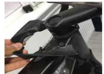
Fixieren Sie Vorbauabdeckungen mit der M3-Schraube (2 Nm)
