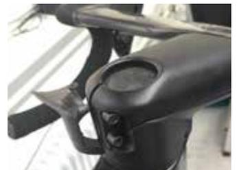
Schließen Sie zuerst die rechte Abdeckung. Platzieren Sie danach die Vorbauabdeckung entsprechend eng um den Vorbaukörper herum
