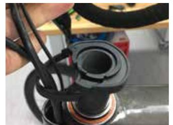
Spacer und Vorbau rasten formschlüssig ineinander ein, um eine entsprechende Ausrichtung sicherzustellen.
