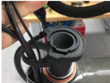
Los espaciadores y la potencia tienen una posición de bloqueo para garantizar su alineación.
