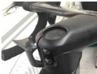
Monte las tapas de la potencia con el tornillo M3 (1 Nm)
