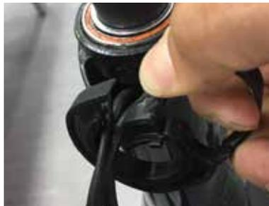
Coloque el espaciador en el tubo de dirección.
