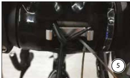
6. Far passare il cavo del deragliatore anteriore e posteriore attraverso l'apertura nella guida del movimento centrale
