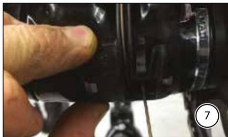
8. Utilizzare un piccolo cacciavite a testa piatta per spingere la clip di fissaggio all'interno finché l'estremità non si innesta all'interno della scatola del movimento centrale.
