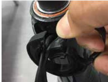
Installez la bague sur le tube de direction.
