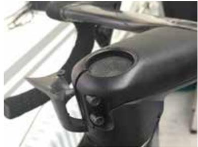
Fixieren Sie die Vorbauabdeckungen mit der M3-Schraube (1 Nm)
