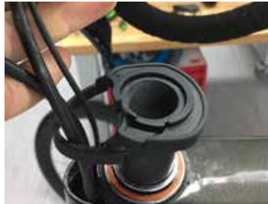
Spacer und Vorbau greifen ineinander, um eine bündige Ausrichtung sicherzustellen.
