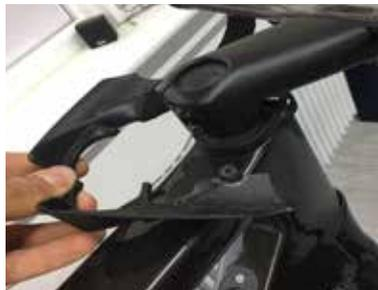
Chiudere prima la copertura destra dell'attacco manubrio, quindi ruotare la copertura sinistra dell'attacco manubrio in posizione intorno al corpo dell'attacco
