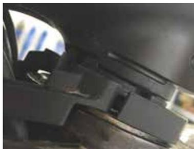
Incarnierare insieme le coperture e farle scivolare sul corpo dell'attacco manubrio. Il corpo dell'attacco manubrio e le coperture sono dotati di un interblocco.
