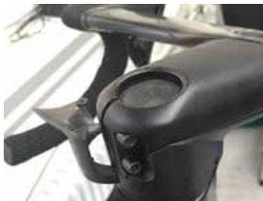
Assemblare le coperture dell'attacco manubrio con un bullone M3 (1Nm)
