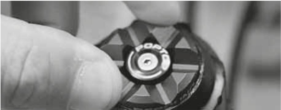
Faites tourner la mollette vers le “-” (sens contraire des aiguilles d’une montre) pour augmenter la vitesse de détente (+ rapide).
