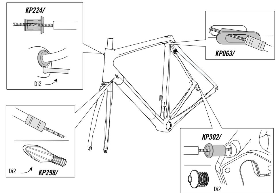
La guida del tubo orizzontale **KP063/** è rimovibile in modo tale che il cavo del freno possa essere instradato all'interno del tubo. La guida viene fissata all'apertura del tubo tendendo il cavo del freno installato. Accertarsi che la guida sia posizionata correttamente nell'apertura del tubo orizzontale quando si installa e si collega il freno posteriore.
