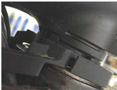
Coloque las tapas y deslícelas sobre el cuerpo de la potencia. El cuerpo de la potencia y la tapas tienen una posición de engranaje.
