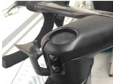
Monte las tapas de la potencia con el tornillo M13 (1 Nm)
