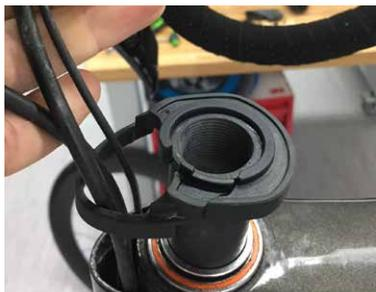
Los espaciadores y la potencia tiene una posición de engranaje para garantizar su alineamiento.
