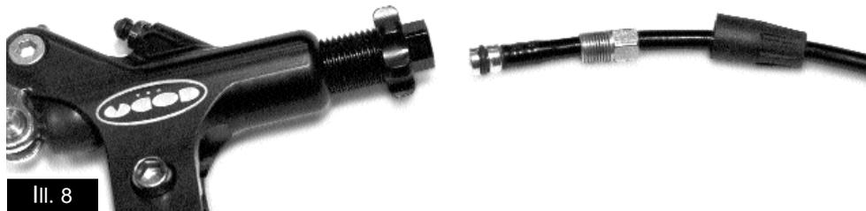
El juego de latiguillos de Frenos de Disco CODA de repuesto incluye nuevos latiguillos, conteras de compresión de repuesto e inserciones para latiguillos hidraulicos.
