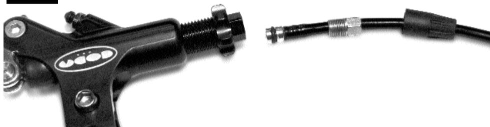
inserti idraulici e due O-rings di colore argento per le leve dei freni.
