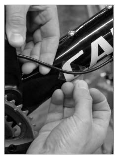
PHOTO ABOVE SHOWS A TYPICAL LOCATION FOR THE GUARD. IN THIS CASE, ITS THE AREA IN FRONT OF THE SWINGARM ON THE DOWNTUBE.
