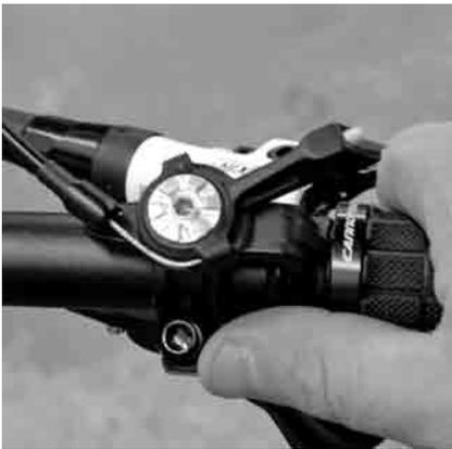
Modalità "corsa corta", ammortizzatore con un volume d'aria ridotto per darti una solida, progressiva risposta. Idraulica di estrazione XC per massimizzare le prestazioni in salita, scorrere sopra gli ostacoli e avere la massima risposta sui sentieri poco accidentati.
