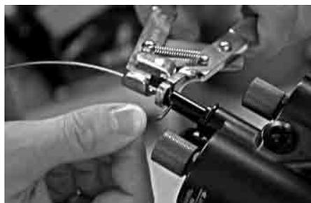
8. Reinstallare il Dyad RT2 nel telaio della bici.
