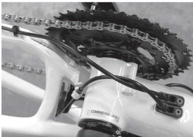
Notare l'orientamento dei fissaggi guaina del tubo obliquo. Le piccole piastre devono essere posizionate sotto le guide (parallele ai cavi) con la parte smussata verso l'alto, come mostrato in figura.
