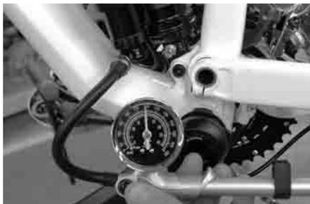
5. **Di nuovo, attaccare la pompa alla valvola della camera dell'aria - negativa e regolare la pressione per lo stesso peso.** Rimettere il tappo della valvola.
