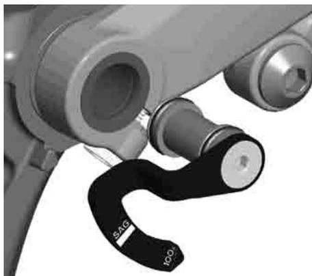
**Le repere de SAG peut etre demonte du pivot du tube oblique en le tirant soigneusement vers l'exterieur.**
