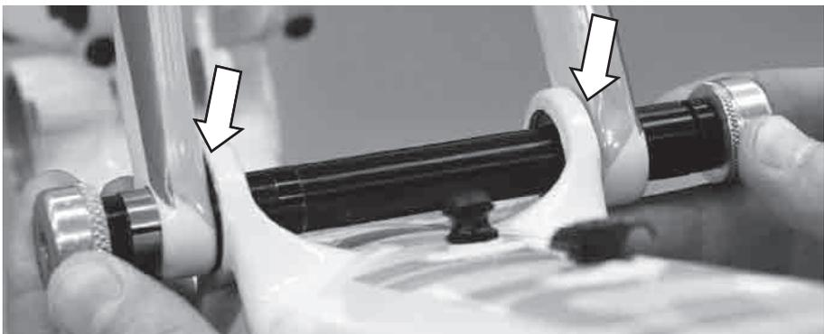
Veuillez utiliser l'outil **KP169**/pour presser l'axe du pivot de la bielette avec la rondelle principale comme indique. Avant de serrer l'ensemble, veuillez vous assurer que la rondelle et l'axe soient positionnés contre le roulement supérieur et que l'espace entre la bielette et le roulement soit identique de chaque côté (flèches).
