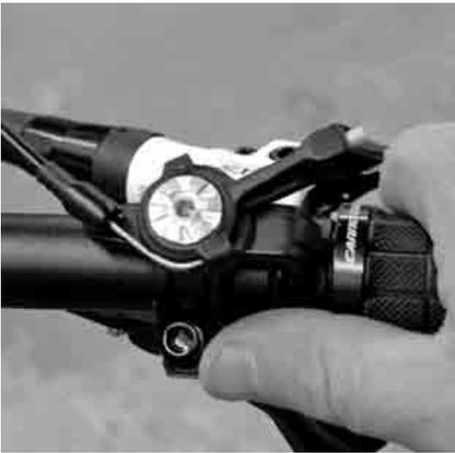
Mode de débattement court avec un faible volume d'air dans l'amortisseur pour une réponse ferme avec une compression progressive, correspondant aux circuits d'amortisseurs XC, aux terrains roulant et aux montées.
