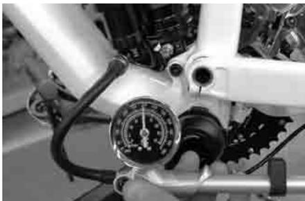
5. De nouveau, raccordez la pompe à la valve de la chambre d'air négative **⊖** et réglez la pression d'air négative pour la même valeur de poids du cycliste. Remettez en place le capuchon de valve.
