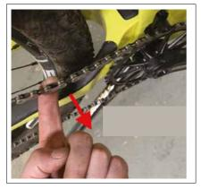
f. Confirme que el guía-cadenas no roza mientras se esté pedaleando en el piñón más grande del cassette, con el SAG correcto del amortiguador (10 mm).
