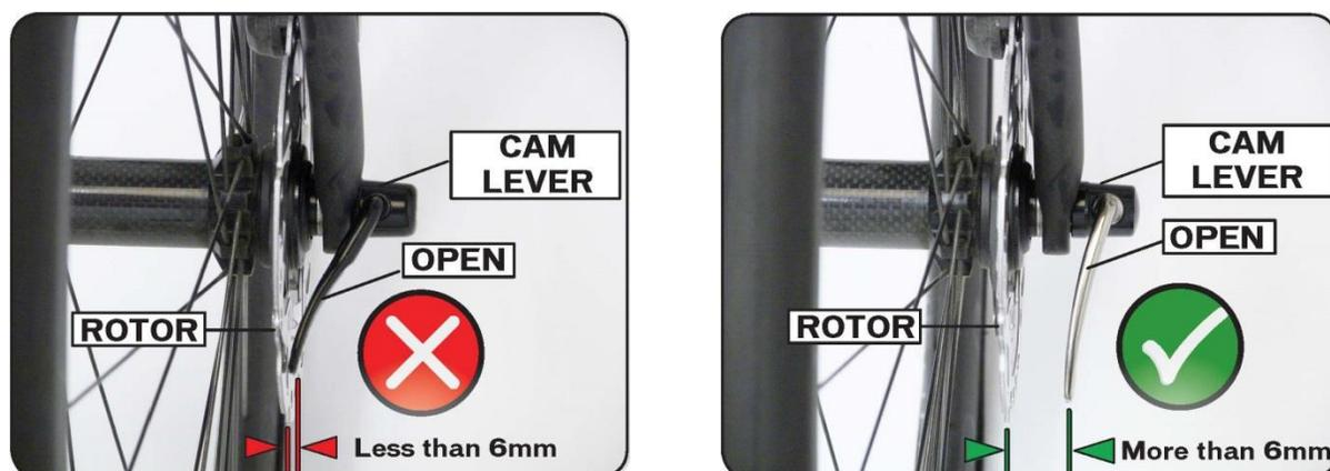
左図：クイックリリースレバーがディスクブレーキローターに接触する可能性がある状態
