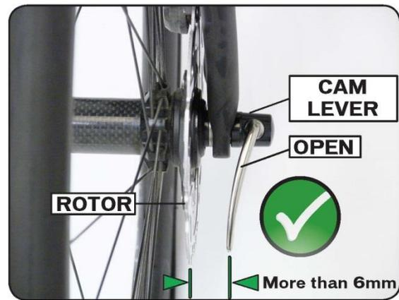
圖2. 快拆杆跟碟盤有足够的間隙
